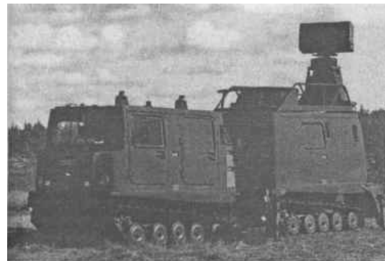
ЗРК в походном положении (во второй прицепе размещена РЛС PS-91 HARD)
