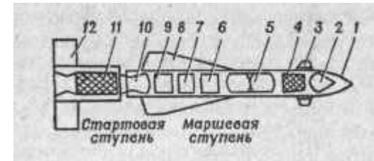
Рис. 6. Схема компоновки гипотетической управляемой ракеты:
