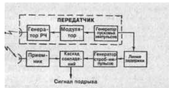
Рис. 8. Структурная схема импульсного радиовзрывателя
