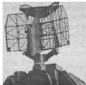
Антенна РЛС обнаружения «Тор-Мі» Оптические средства обнаружения
