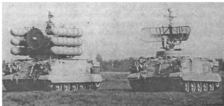
Комплекс в составе самоходной ПУ и самоходной РЛС обнаружения
